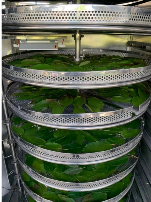
รูปที่ 1 การแปรรูปใบกระท่อมด้วยระบบอบแห้งแบบผสมผสานอัจฉริยะ
